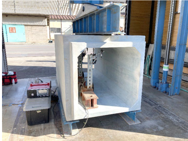
【ボックスカルバートの曲げ耐力試験の様子】
