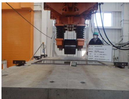
250kN、10万回載荷後の水張試験状況 （漏水なし）
