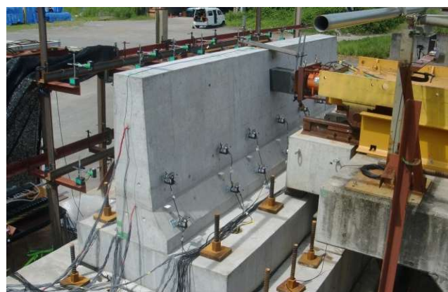
衝突試験状況（NEXCO試験法441）
