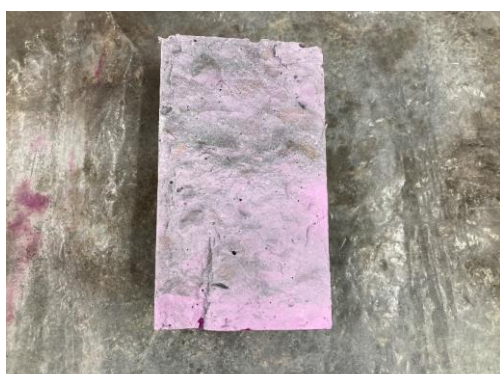
写真-2 水分浸透深さの確認状況（浸せき 150 h）
