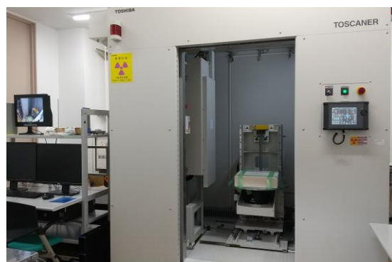
写真-1 撮影に供した TOSCANER-34500FD (国立大学法人室蘭工業大学所有)
